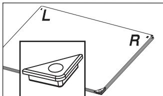
Em seguida, substitua o 2º vidro da porta, posicionando-o sobre o primeiro. Substitua o conjunto dos painéis de vidros exteriores da porta.
